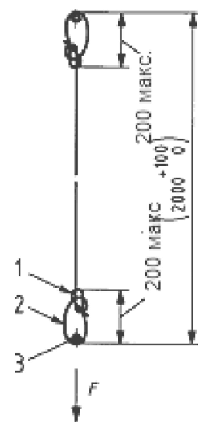
$F$  – масса  $100^{+1}$  кг или эквивалентная сила; 1 – узел булинь; 2 – петля заделки конца; 3 – точка/ушко для подсоединения
